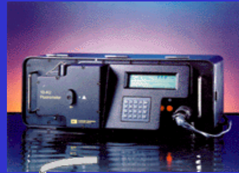
fluorímetro, para estudios con trazadores y/o clorofila
