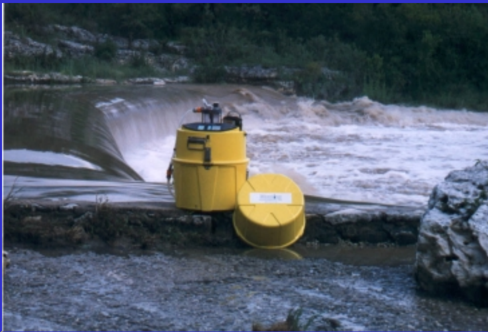
muestreador automático programable, con 24 frascos
